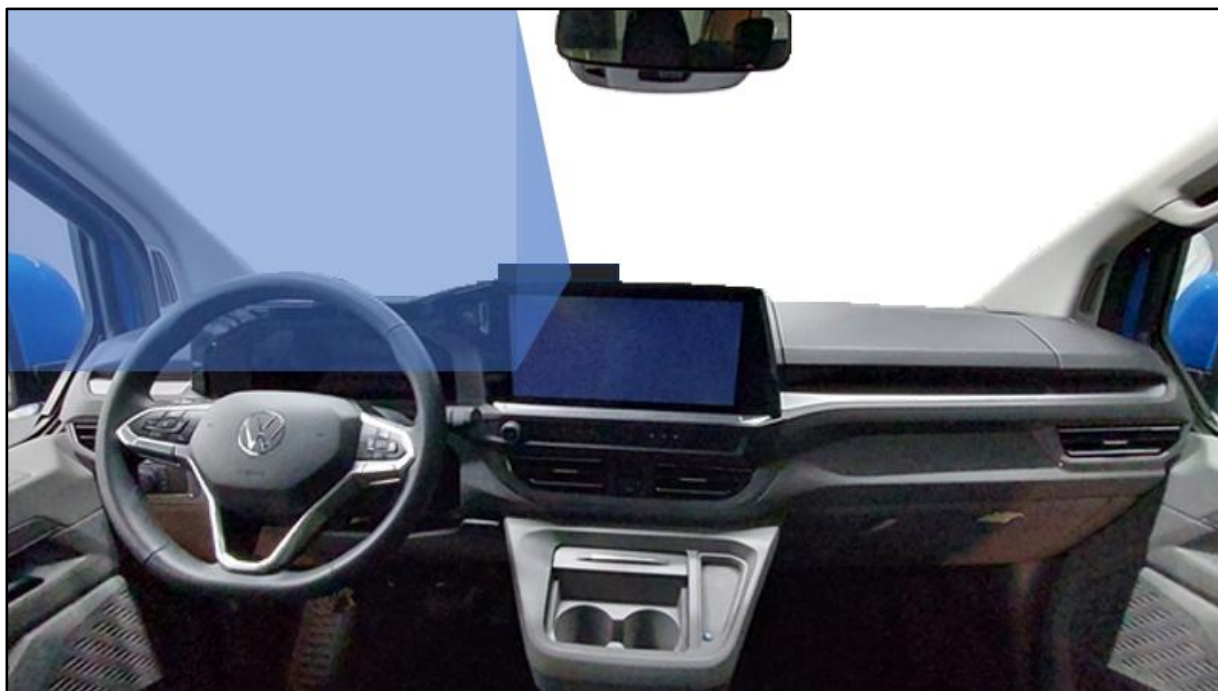
Obr. 1: Poloha a zorné pole modulární vnitřní kamery
