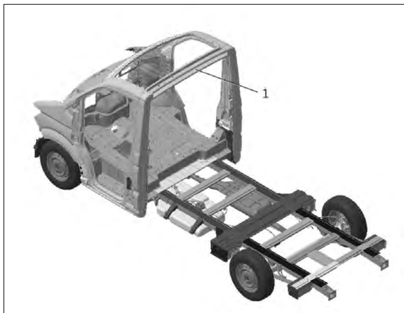
Obr. 1: Panel kapoty s plochým rámovým podvozkem (K4Z) / 1-přídavná střešní příčná vzpěra pro přepravu
