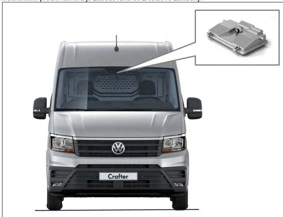
Obr. 1: Poloha přední kamery pro asistenční systémy ve vozidle
