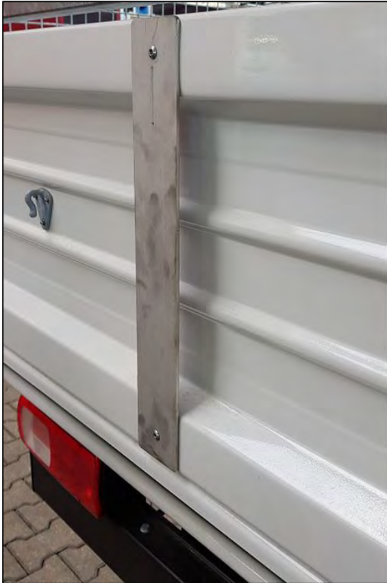
Obr. 3: Stírací lišta na zadní stěně plošiny
