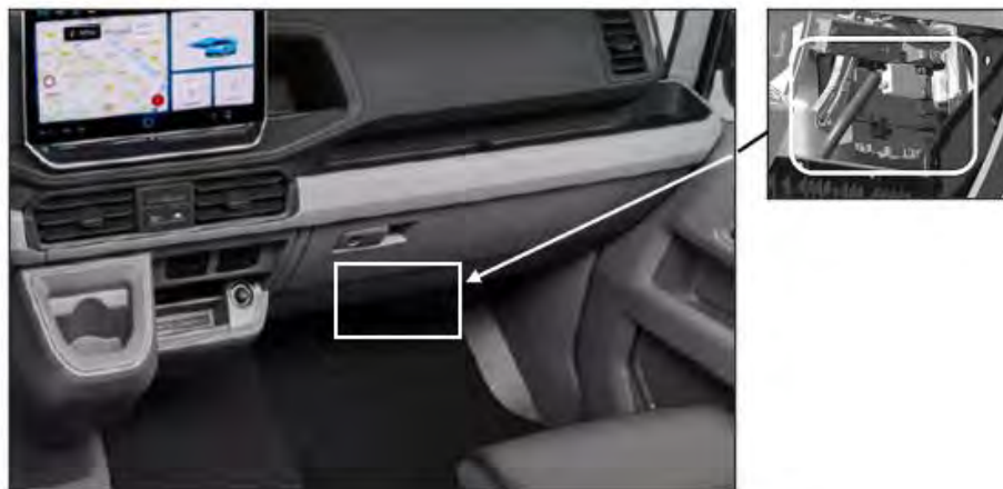
Montážní poloha CFCU na spodním panelu palubní desky za odkládací schránkou
