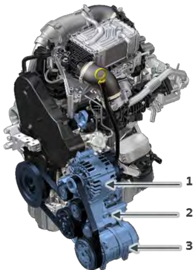
Systém pomocného náhonu s přídavným kompresorem klimatizace
