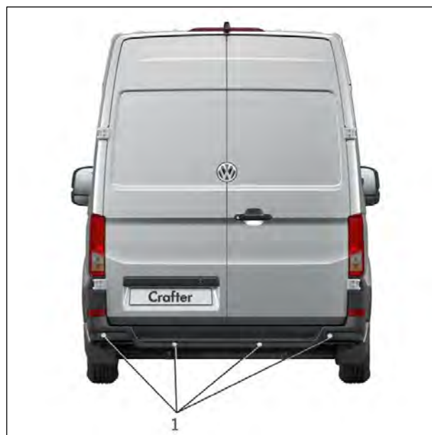
Obr. 2: Poloha ultrazvukových senzorů
