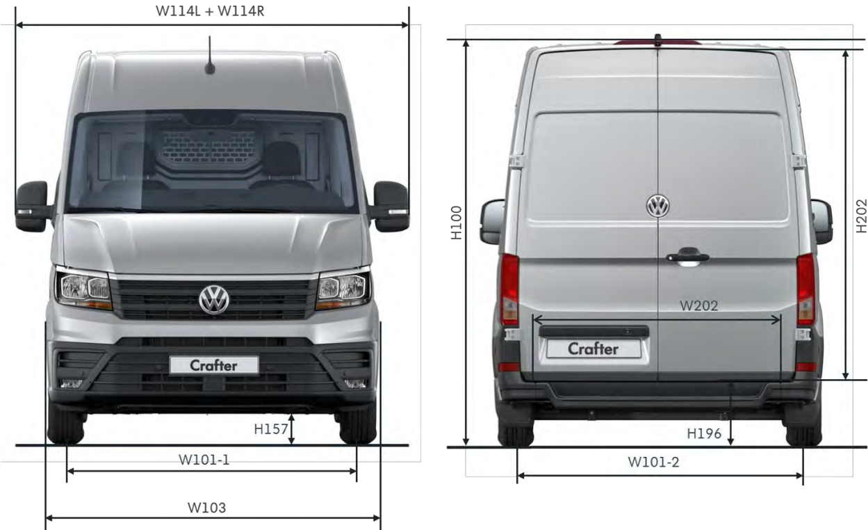
Obr. 3: Rozměry vozidla, skříňová dodávka / pohled zepředu a zezadu
