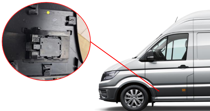
Obr. 3: Poloha radarových snímačů ve dveřích
