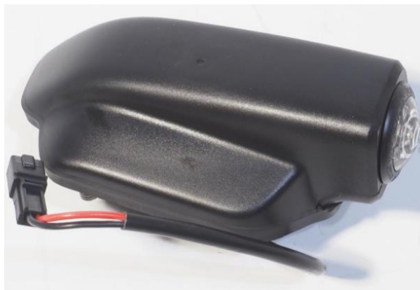
Obr. 3: Pravé a levé boční obrysově světlo, objednací číslo: 7C0 941 061 C
