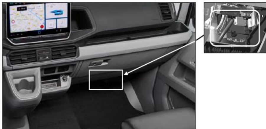
Montážní poloha CFCU na spodním přístrojovém panelu, za přihrádkou před spolujezdcem
