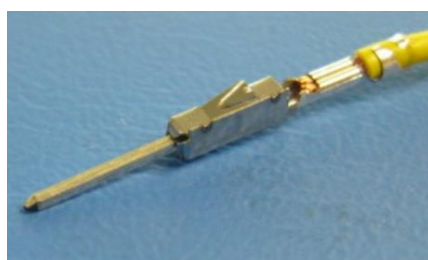
Obr. 5: Spojovací konektor pro spojovací stanici palubního napájecího konektoru, objednací číslo: 8W0 972 575 a sada jednotlivých vodičů s kontakty, objednací číslo: 000 979 012 E
