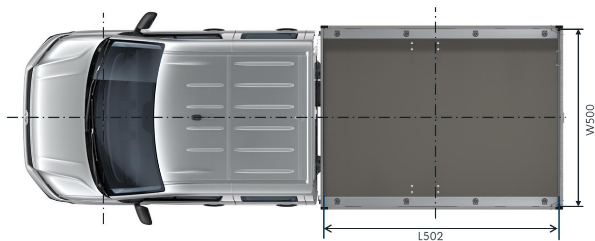
Obr. 2: Rozměry vozidla, jednoduchá kabina, plošina dodávka/pohled shora
