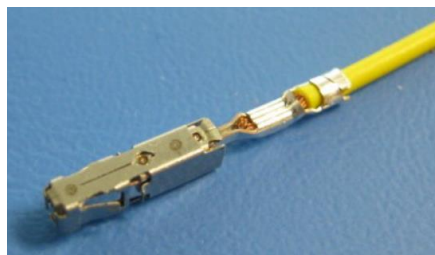
Obr. 6: Protilehlý konektor "Příprava spojovacího bodu pro rotující světlo" s jedním vodičem a kontakty
