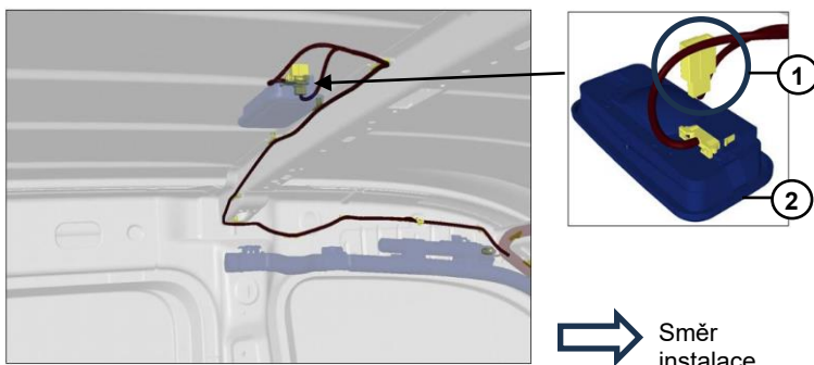
Obr. 4: Poloha spojovacího bodu pro střechu, pro otočné světlo na dvojitě kabině
