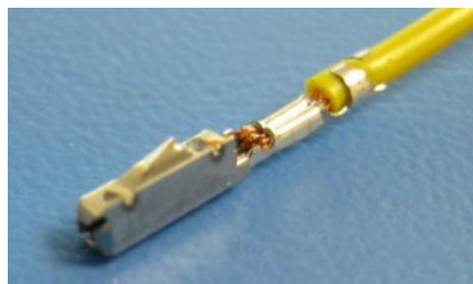
Obr. 4: Protilehlý konektor pro boční obrysové světlo, objednací číslo: 8W0 971 832 a sada jednotlivých vodičů s kontakty, objednací číslo: 000 979 009 E.
