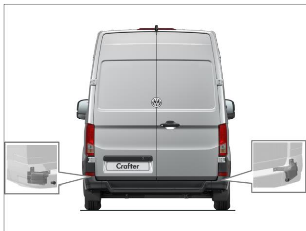
Obr. 1: Poloha radarových snímačů v zadním nárazníku
