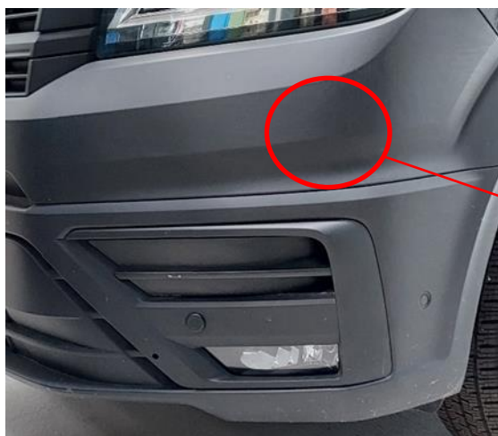
Obr. 3: Poloha radarových snímačů za krytem předního nárazníku
