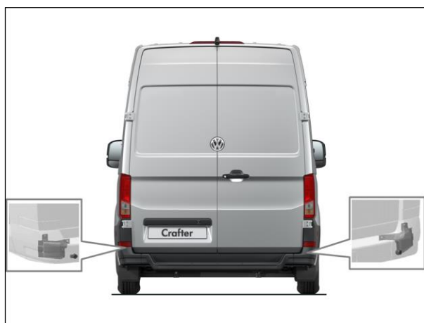
Obr. 3: Vlevo a vpravo poloha radarových snímačů za krytem nárazníku
