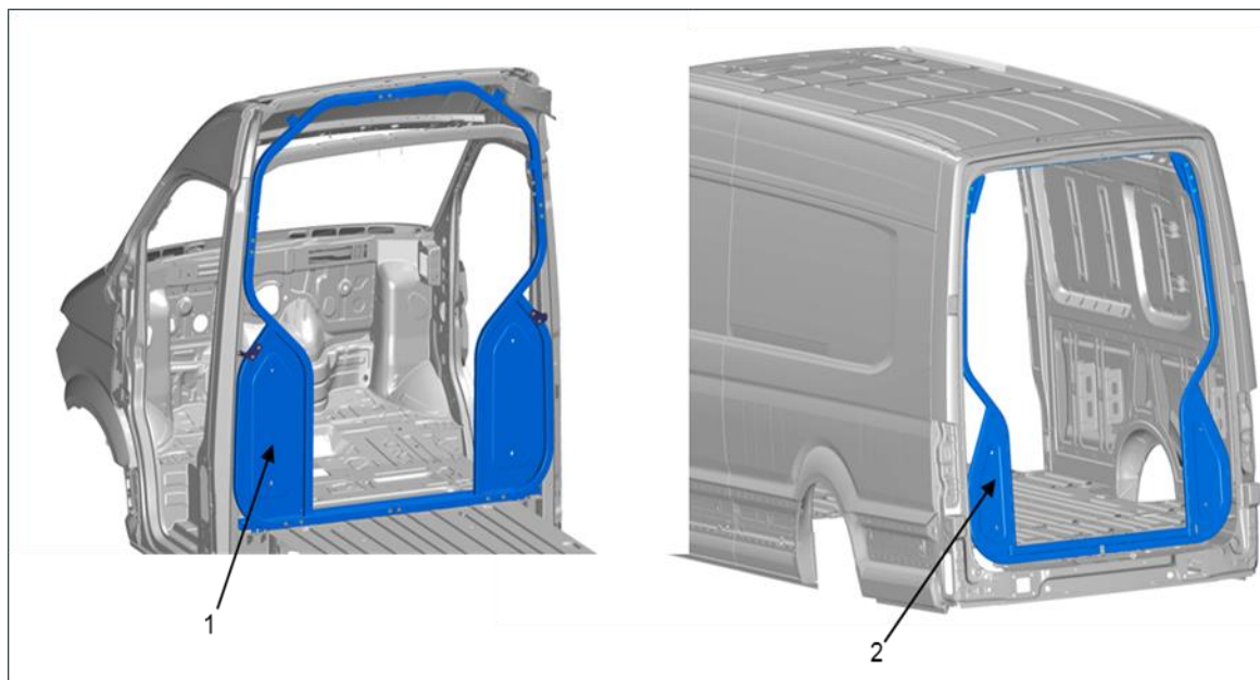
Obr. 1: Ochranný rám (PR č. 2Y1)
