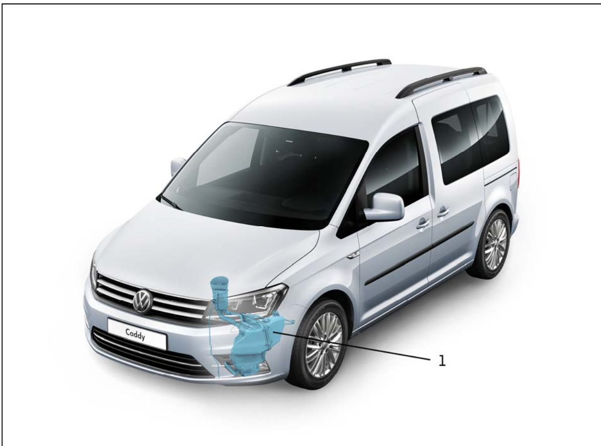
Obr. 1 Montážní poloha nádrže na AdBlue ve vozidle
