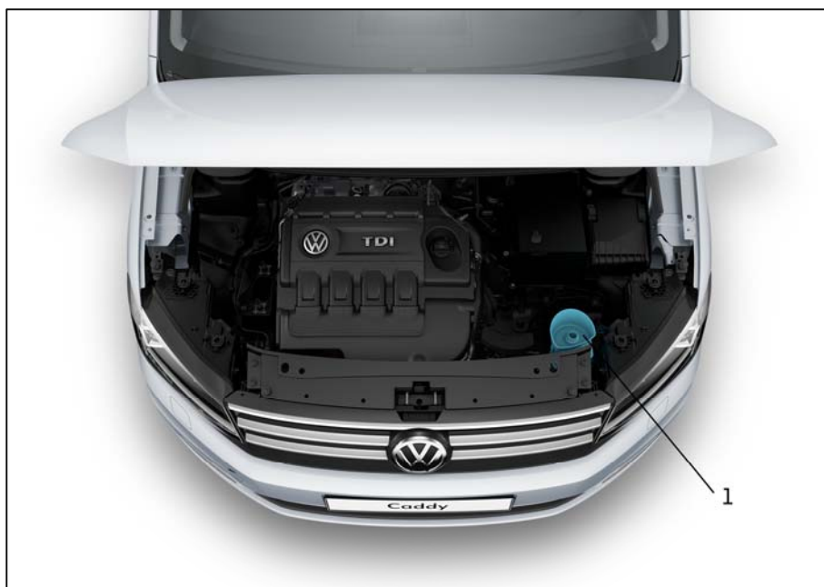
Obr. 2 Plnicí otvor nádrže na AdBlue® v motorovém prostoru
